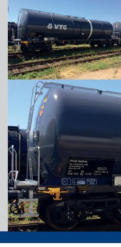
Optimiert für den Transport von Flüssiggütern mit einer Dichte von 0,845 bis 0,93 t/m³, wie bspw. Mineralöl-Mitteldestillate, Biodiesel oder Sonnenblumenöl. Der Einsatz für Produkte der RID-Klassen 6, 8 und 9 ist ebenfalls möglich.
