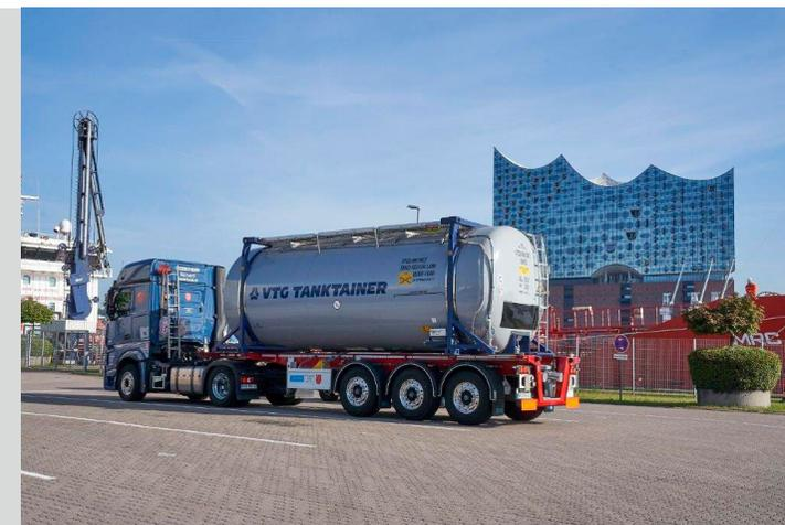
Der Tankcontainer ist komplett flurbedienbar und verfügt über eine Anzeige für die Öffnungsstellung des Luftventils. Er verfügt über eine großflächige Heizung sowie einen beheizten Bodenventilflansch. Durch das Schwallwanddesign sind Reinigung sowie Sauberheitskontrolle einfach und unkompliziert. Eine Mindestfüllung ist aufgrund der Schwallwände nicht notwendig. Bei Bedarf kann an der Dampfheizung eine Temperatursensoren mit GPS-Übertragung nachgerüstet werden.
