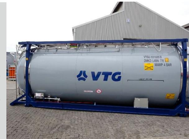
Der Tankcontainer ist komplett von unten bedienbar und verfügt über eine Anzeige für die Öffnungsstellung des Luftventils. Er verfügt über eine großflächige Heizung sowie einen beheizten Bodenventilflansch. Bei Bedarf kann an der Dampfheizung eine Temperatursensorik mit GPS-Übertragung nachgerüstet werden.
